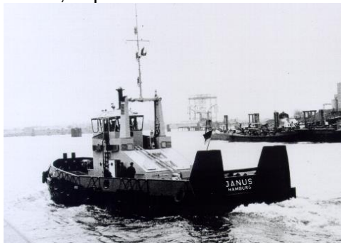
Imágenes 3 (SCHOTTEL_100 Jahre_03.jpg) Janus, el primer remolcador con las hélices timón SCHOTTEL
