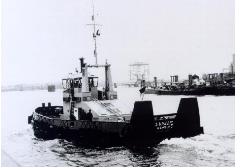
Bild 3 (SCHOTTEL_100 Jahre_03.jpg) Janus: the first tug with SCHOTTEL RudderPropellers
