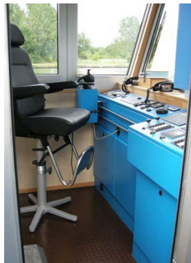
Steering desk with Copilot control lever Steuerstand mit Copilot Steuerhebel
