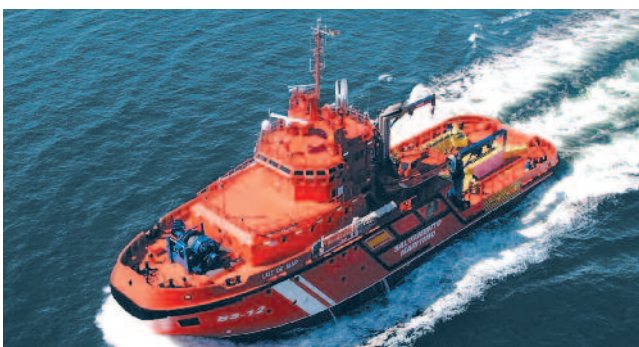
128 T BP OFFSHORE TUG LUZ DE MAR 2 x SCHOTTEL Rudderpropeller Type SRP 3040 CP (3840 kW each)
