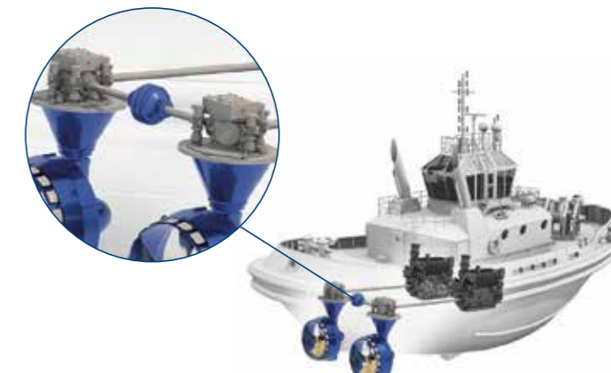
SYDRIVE-M mit zwei Dieselmotoren, die getrennt oder kombiniert aktiviert werden können
