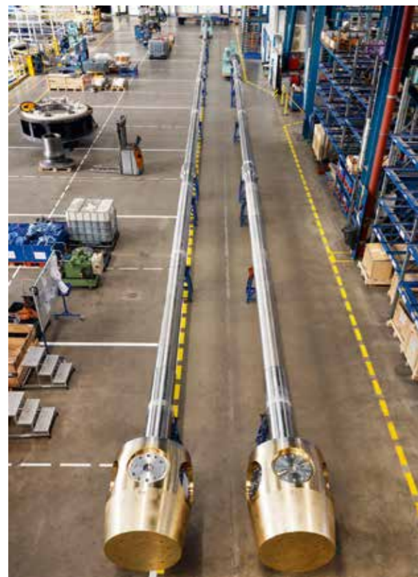
Neue fünfblügelige Nabe, hier links mit 50 Meter langem Wellenstrang
