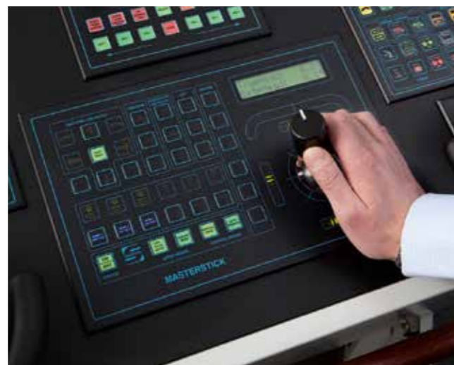
Joystick-System zur Bedienung von sechs Antrieben, 2010
