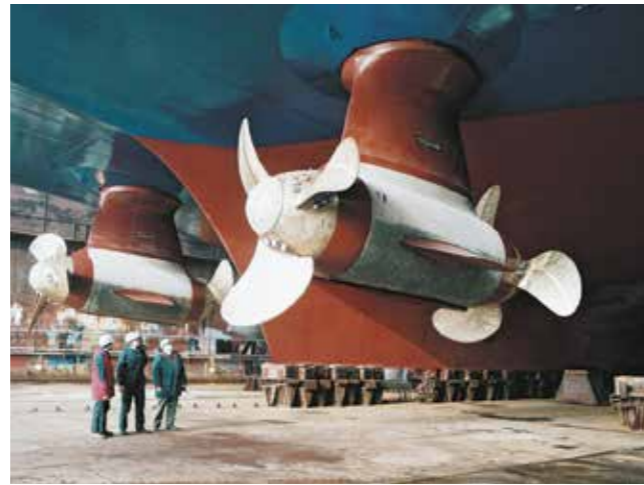
Siemens-SCHOTTEL-Propulsor (SSP), ein um 360 Grad drehbarer Gondelantrieb mit integriertem Elektromotor; hier: die Fähre Nils Holgersson
