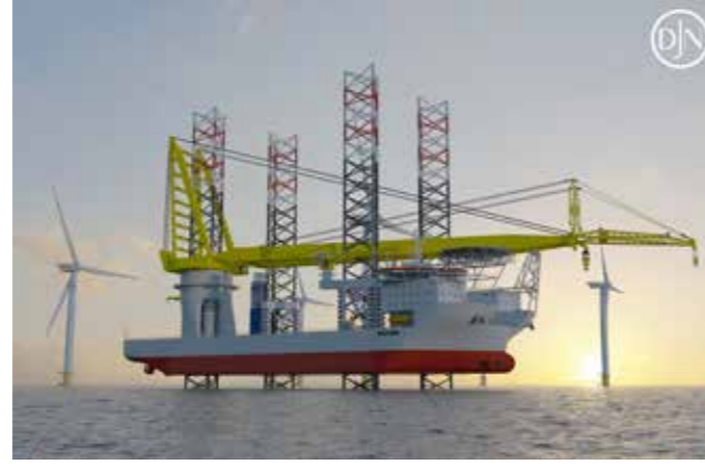
Aktuelle Offshore-Referenz: Mit einer Nutzlast von rund 14.000 Tonnen und einer Krankapazität von über 3.000 Tonnen wird das Errichterschiff Voltairre ab 2022 die Branche der erneuerbaren
